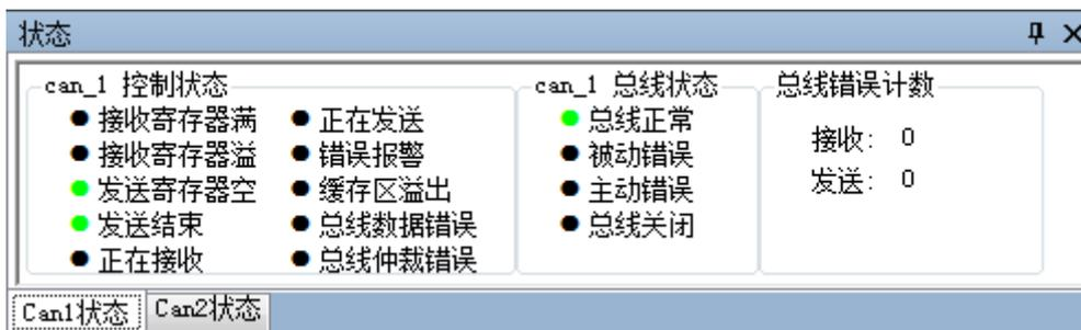
**CAN总线状态显示:** 指示当前CAN总线状态包括：总线正常、被动错误、主动错误、总线挂起。
