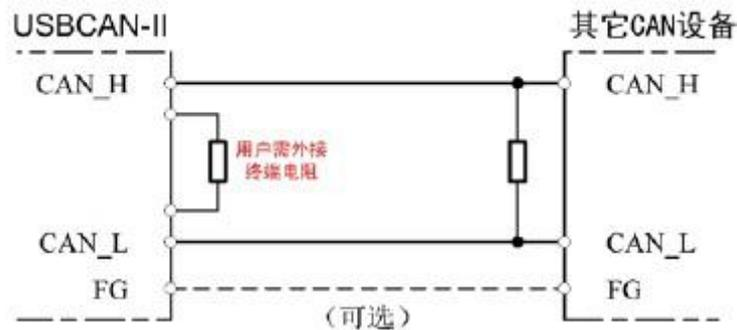
图3.2 USBCAN-II Pro与其他CAN节点设备连接
