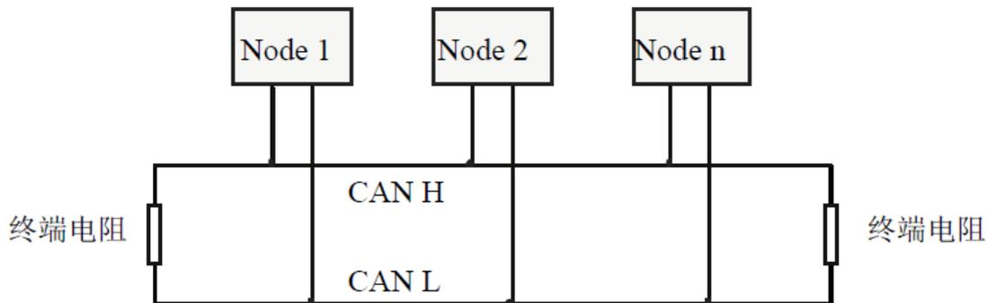
图 3.1 CAN-bus 网络的拓扑结构
